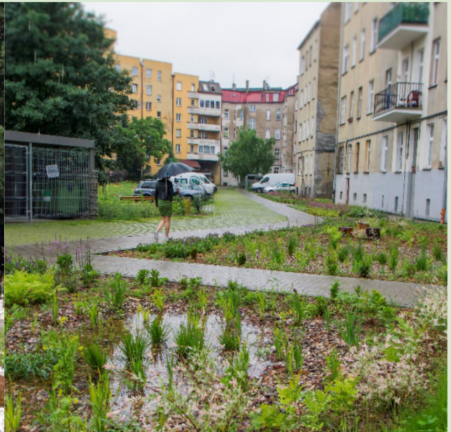
Gromadzenie deszczówki w ogrodzie deszczowym
