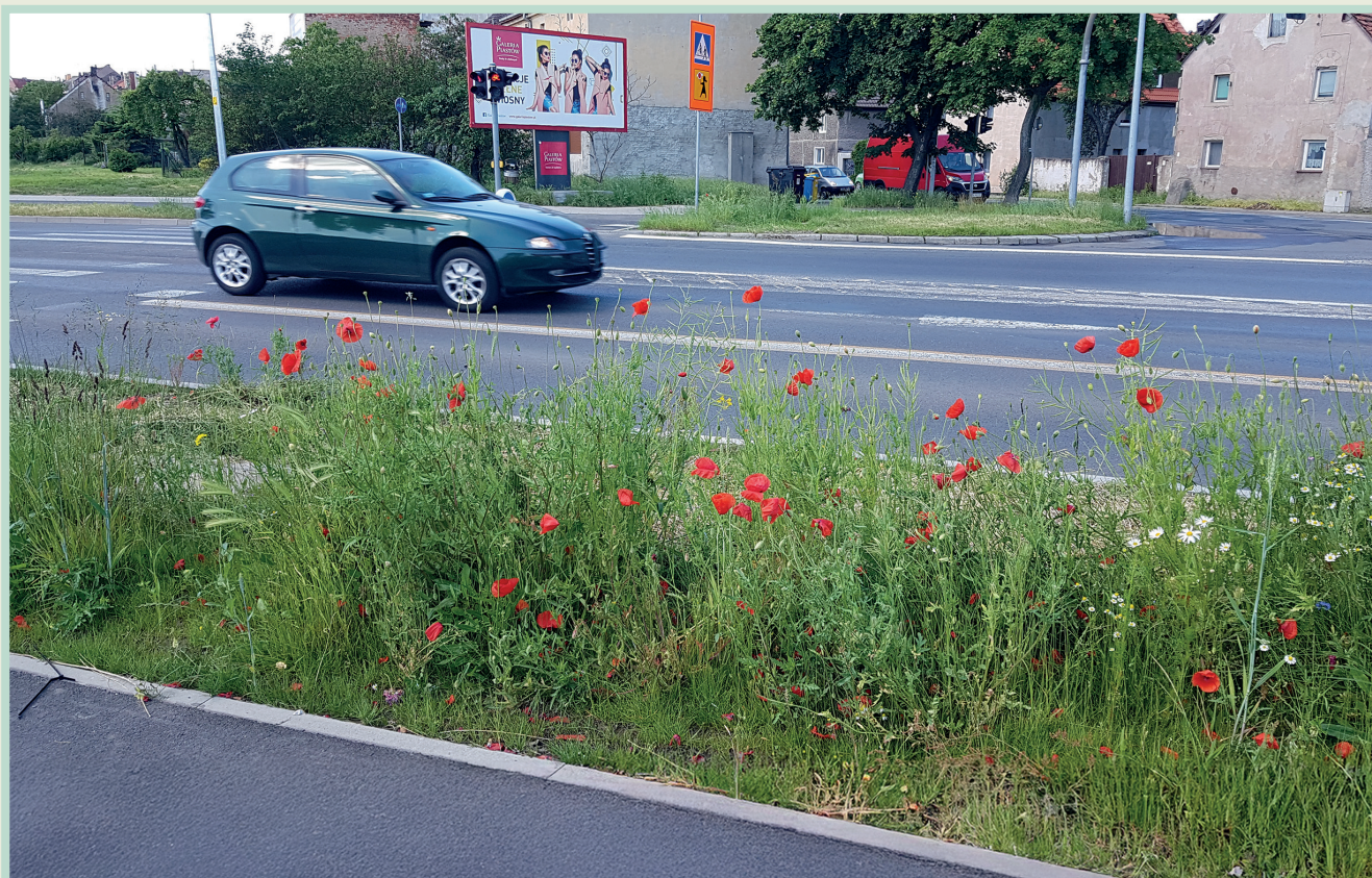
Zieleń przyuliczna o charakterze naturalnym – pas roślinności kwietnej poprawia mikroretencję, zwiększa infiltrację wód opadowych, obniża temperaturę otoczenia i wspiera bioróżnorodność w przestrzeni miejskiej.
