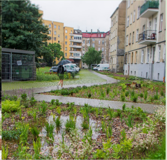
Gromadzenie deszczówki w ogrodzie deszczowym
