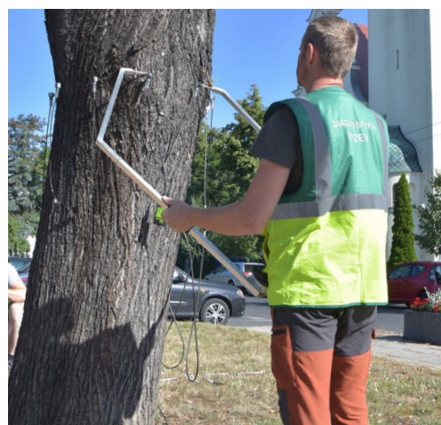
Badanie pnia tomografem sonicznym (dolne zdj.) wraz z przykładowym wynikiem badania (rys. na górze); (fot. J. Józefczuk)
