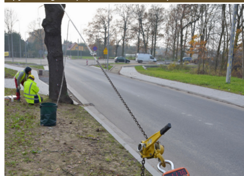
Badanie drzewa próbą obciążeniową (fot. J. Józefczuk)
