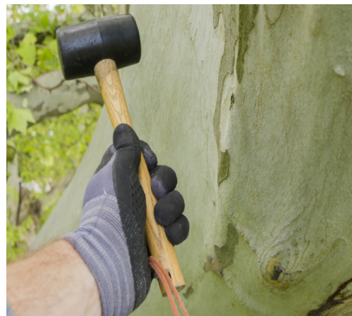
Badanie pnia młotkiem diagnostycznym (fot. J. Józefczuk)
